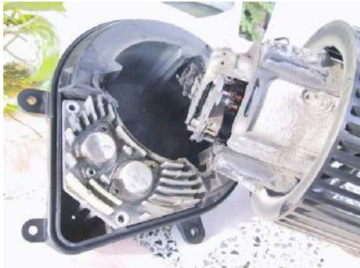
Hay que cambiar los transistores originales FW2G025A1 por 2 nuevos y equivalentes ya que la numeración utilizada no es comercial, se busca en el fabricante y se encuentra un equivalente, el 2N6287 que es un par Darlington de 20 A.
