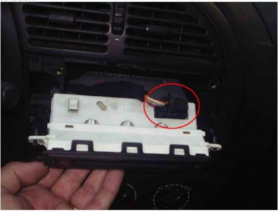
Ahora lo que nos queda es repetir el proceso inverso y montar la nueva primero poniendo el conector, encajándola y atornillándola y volver a colocar el marco.
